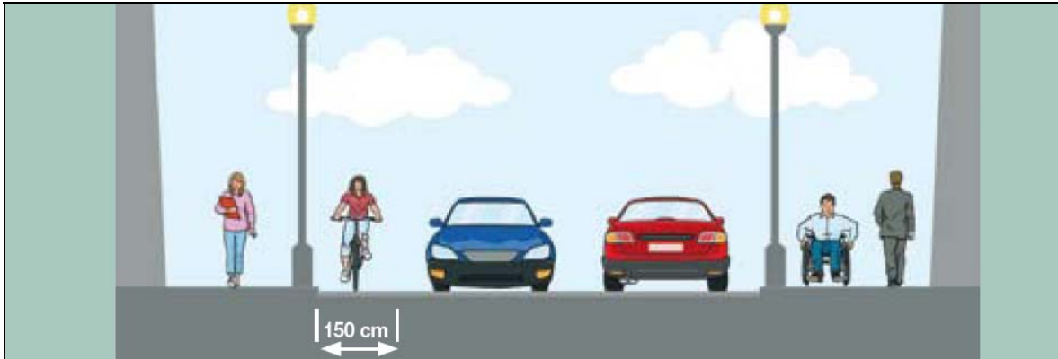
Il·lustració 6: Carril bici unidireccional en zona urbana. Font: Manual pel disseny de vies ciclistes a Catalunya.
